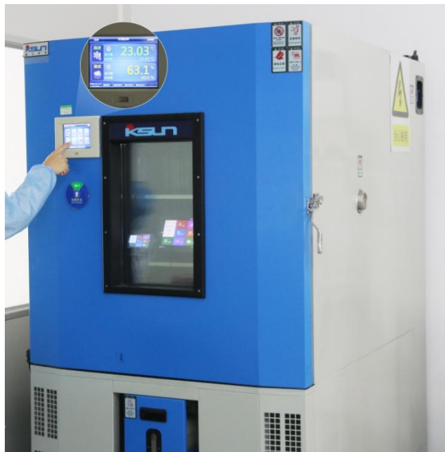
图 7-3 高低温老化测试图
